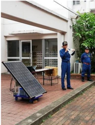
足温ネットが作成した「移動式太陽光パネル自立電源」(発電出力150W)
